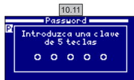
10.11 Password: Permite proteger el acceso al menú de usuario activando un password. Pulse una combinación de 5 teclas y el sistema las memorizará. Si se olvida el password, existe una "master-password" de Servicio. Solicítelo al instalador/proveedor.
