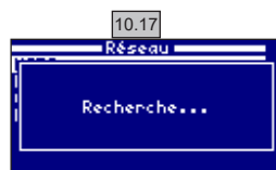
10.17 Sélectionnez le réseau souhaité. Saisissez le mot de passe sur le clavier pop-up. Appuyez sur les touches haut/bas pour vous déplacer vers le haut et vers le bas, ainsi que sur les touches plus/moins pour vous déplacer vers la gauche et vers la droite. Pour sélectionner une lettre, appuyez sur OK.
