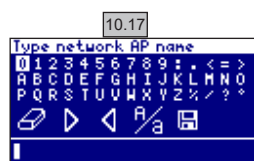
10.17 Das gewünschte Netzwerk auswählen. Geben Sie das Passwort mithilfe der Tastatur im Pop-up-Fenster ein. Drücken Sie die Tasten nach oben/nach unten, um den Cursor nach oben oder nach unten zu bewegen, sowie die Tasten MEHR/WENIGER, um den Cursor nach links und rechts zu bewegen. Um einen Buchstaben auszuwählen, drücken Sie OK.
