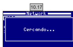
10.17 Selezionare la rete desiderata accessibile al modulo Wi-Fi. Digitare la password sulla tastiera pop-up. Spostarsi in alto e in basso con i tasti su/giù e da sinistra a destra con i tasti più/meno. Per selezionare una lettera premere OK.
