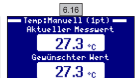
6.16 Korrigieren Sie mit den Tasten MEHR/WENIGER den von der Sonde angezeigten Messerwert, bis er mit dem Referenzwert übereinstimmt. Anschließend OK drücken.
