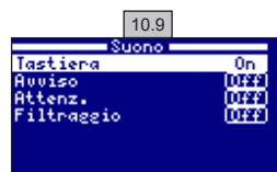
10.9 Suono: Programmare l'emissione di suoni per le funzioni: Tastiera (tasti); Avviso (messaggi pop-up); Attenz. (allarme di funzionamento); Filtraggio (inizio della filtrazione).
