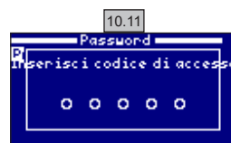
10.11 Password: Permette di proteggere l'accesso al menù utente attivando una password. Per inserire il codice di accesso il sistema la memorizzerà. Se la password viene dimenticata, è prevista una "password master". Chiedere all'installatore/fornitore.
