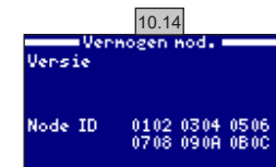
10.14 System info. Informatie over de softwareversie van het TFT-scherm en de vermogenmodule. Op dit scherm ziet u ook de Node ID die nodig is om de WiFi-verbinding te configureren.
