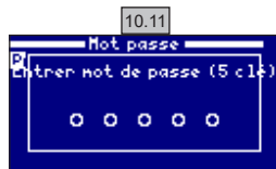
10.11 Mot de passe : Permet de protéger l'accès au menu utilisateur par un mot de passe. Pour indiquer votre mot de passe, appuyez sur une combinaison de 5 touches. Le système les mémorisera. Si vous oubliez votre mot de passe, il existe un « mot de passe principal ». Contactez votre installateur/fournisseur.
