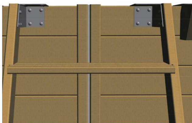
Figure 17 – Bevestiging van de buitentrap aan het zwembad
